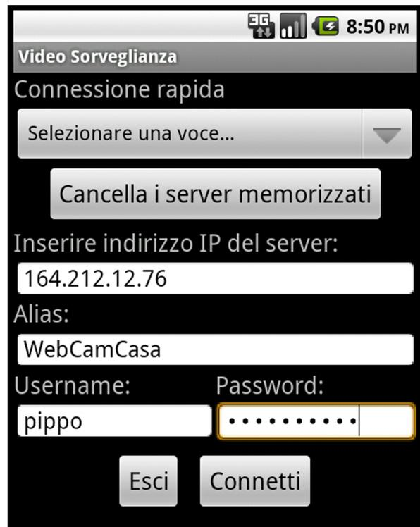
Figura 7. L'interfaccia grafica dell'activity del login. Ad ogni connessione riuscita viene salvato un record nelle preferenze condivise dell'applicazione, che consente, in seguito, la connessione rapida.
